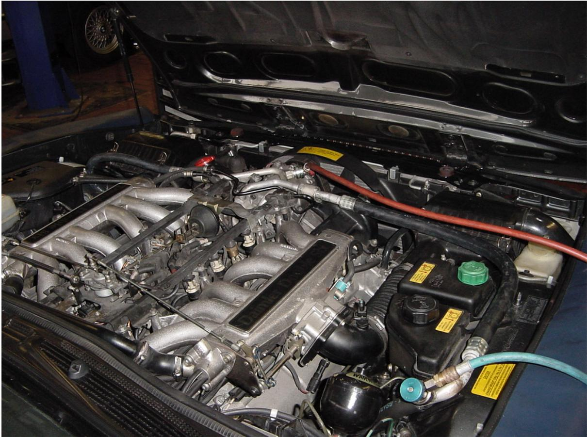
**Abbildungen 19: Die Klimaanlage wird befüllt**
