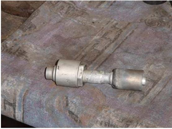
**Abbildung 14: Fertig gelötetes Element**
