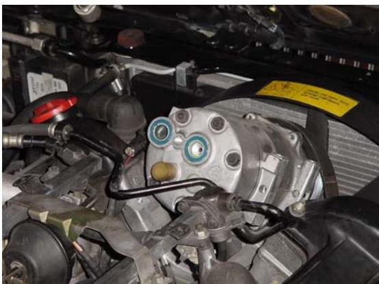
**Abbildungen 17: Der Klimakompressor von der Rückseite, der Anschlussseite, mit den Dichtungsanschlüssen**
