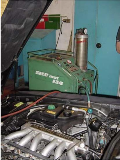
**Abbildung 4: Kältemittelfüll- und Evakuationsmaschine**
