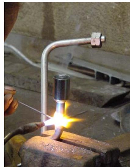
**Abbildungen 12 + 13: Die neue Quetschverbindung wird an das alte Rohr angelötet**
