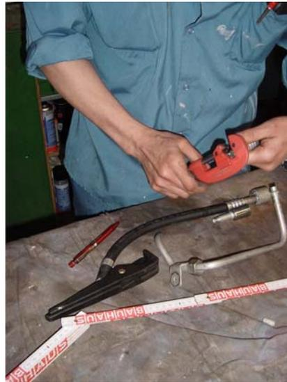
**Abbildung 10: Trennen der Gummischläuche von den Alurohren**
