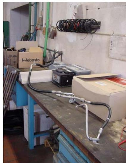
**Abbildung 8: Demontiertes Klimaschleuchtensystem des DD6 (XJ 81)**
