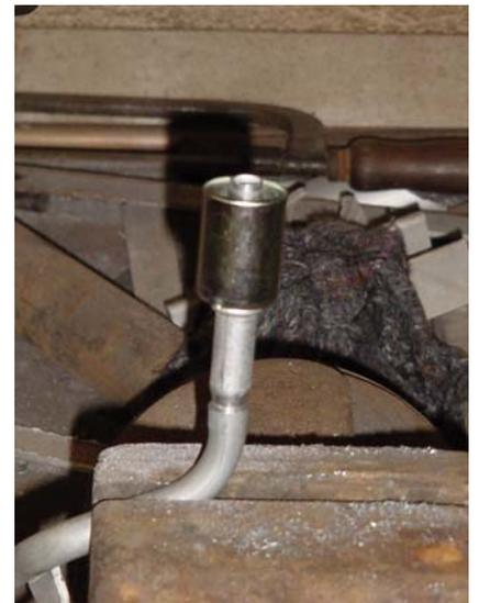
**Abbildung 11: Die neue Quetschverbindung für den Gummischlauch ist bereits in das geweitete Alurohr gesteckt und wartet auf die Verlötung.**
