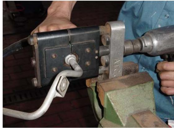
**Abbildungen 15 + 16: Der neue Gummischlauch wird mit Spannvorrichtungen und Schlagschrauber in der Quetschverbindung gepresst**
