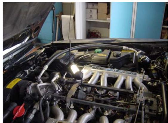
**Abbildungen 18: Die neuen Schläuche sind montiert**
