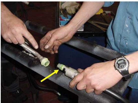
Nach der Demontage der Klimaanlage kam bei unserem DD 6 zum Vorschein, dass die Dichtungen – die Dichtringe haben formmäßig Ähnlichkeit mit O-Ringen – zum Teil sehr stark vom Kältemittel zerfressen und dadurch undicht waren.
