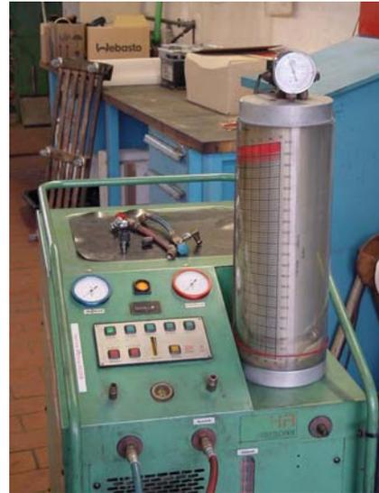
**Abbildung 5: Füllstandsanzeige nach dem Evakuieren**
