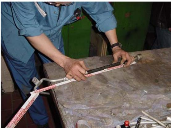
**Abbildung 9: Vor dem Abtrennen werden die Schlauchlängen gemessen**
