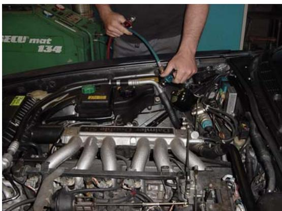
**Abbildung 2: Vorbereitung zum Evakuieren des Kältemittels aus dem Klimasystem auf der Saugseite**
